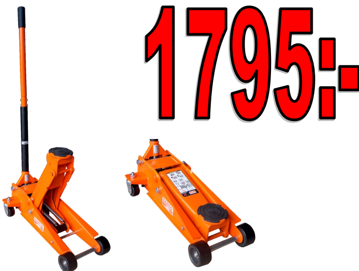
Art nr: 02BH1EU3000 Bahco domkraft 3t kompakt Ingångshöjden är 130 mm och maximal lyfthöjd 462 mm Listpris: 3250:- Ex moms!
