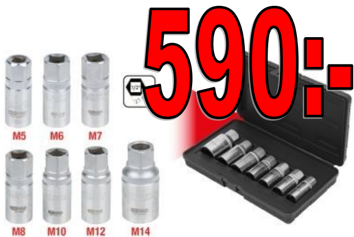
Art nr: 05152.1101 Pinnbultsutdragare, sats 7-delar Pinnbult utdragarsats. 1/2". M5 - M14, SW 21 mm. med utvändigt sexkantsdriv. Med höger- och vänsterspännfunktion. Säkert fäste genom 3 rullvalsar vardera. In- och utskruvning utan besvärlig låsning av två muttrar på bulten Lämpad även för extralånga ståbultar - på grund av den genomgående borrningen. Ord listpris: 1675:- Ex moms!
